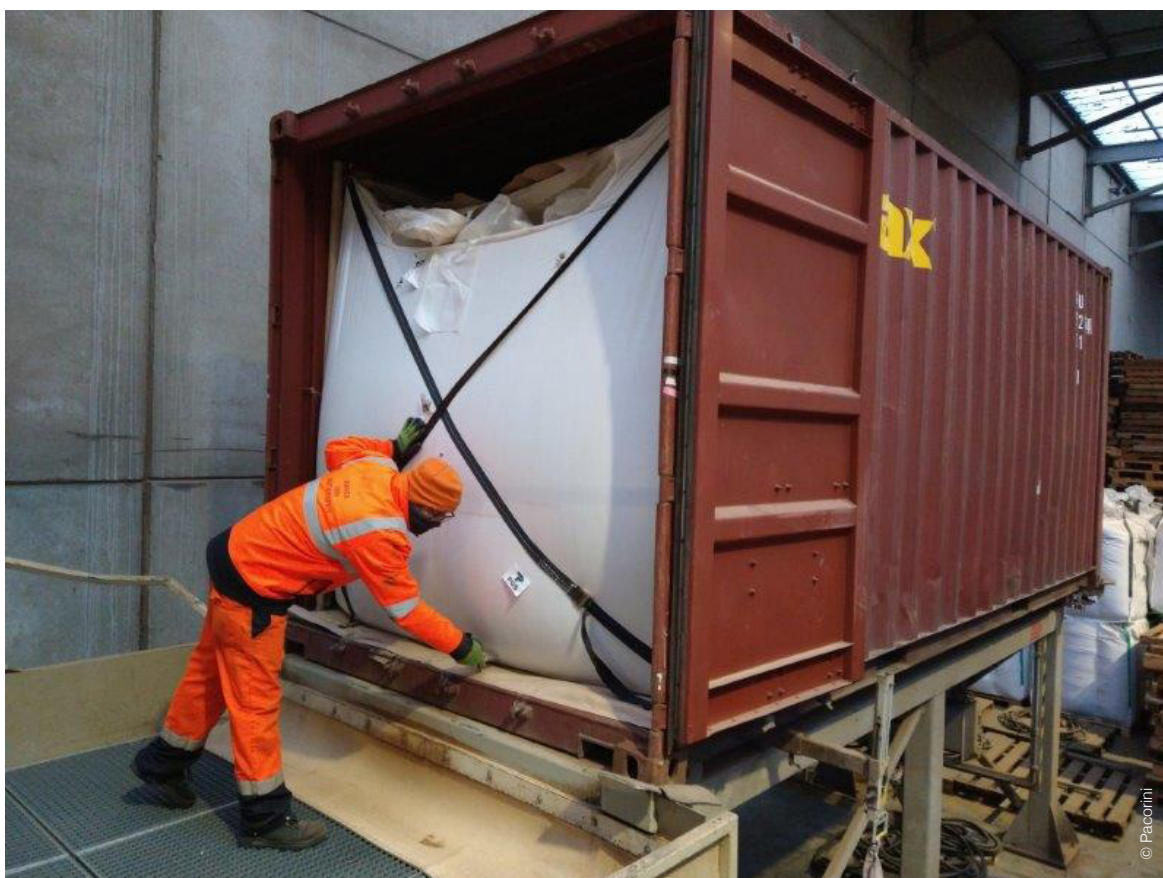
Revestimento de café seco a granel
